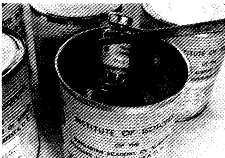
Radioaktív készítmény sugárbiztos csomagolása
