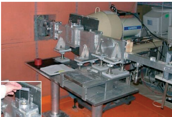
1. ábra. Prompt-gamma aktivációs analízis mérőegység részlete
